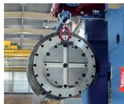
Walzenwechsellvorrichtung: In weniger als 10 Minuten ist der Walzenwechsel durchgeführt
