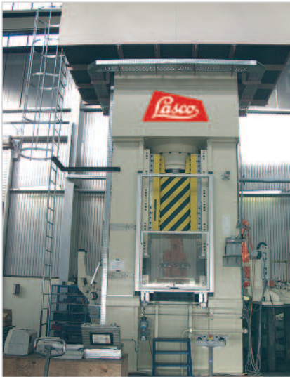
KFP 1000 utilisée pour le formage de pièces aluminium pour l'industrie automobile.
