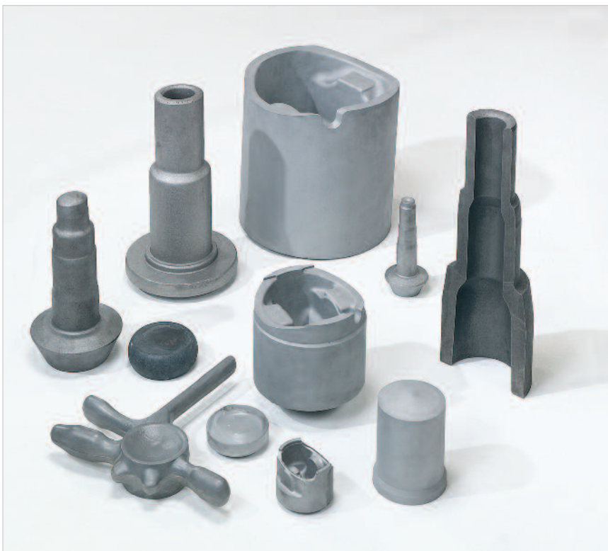
Pièces typiques préformées et finies sur presses hydrauliques LASCО de la série VP.
