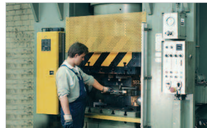
Travaux de calibrage sur KP 500.
