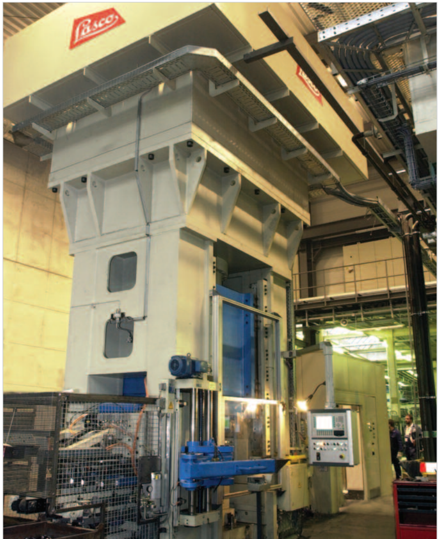
Presse d'extrusion à froid LASCO KFP 1000 pour la production de pièces automobiles. Une parmi plus de 1000 presses hydrauliques LASCO en service dans le monde entier chez des utilisateurs industriels.
