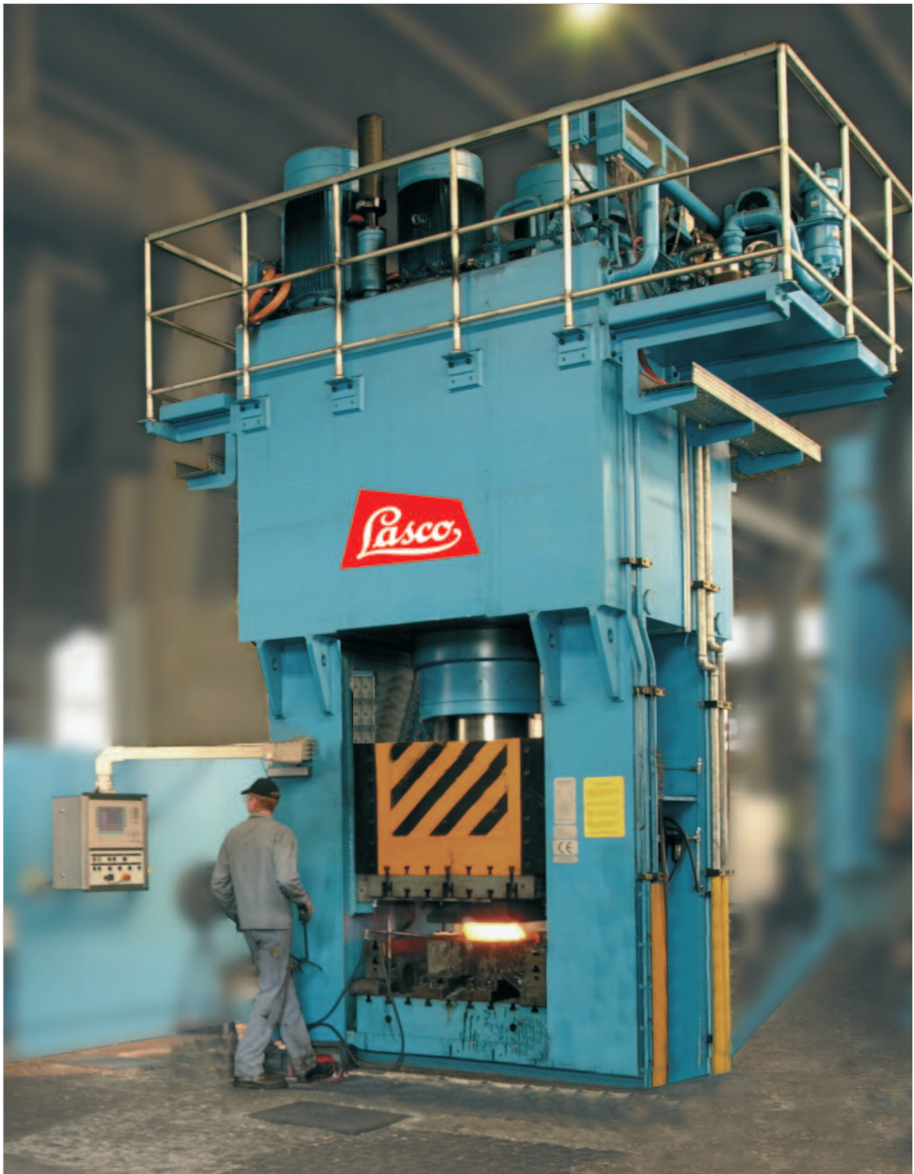
Fabrication d'ébauche annulaire sur une LASCO VPE 800.
