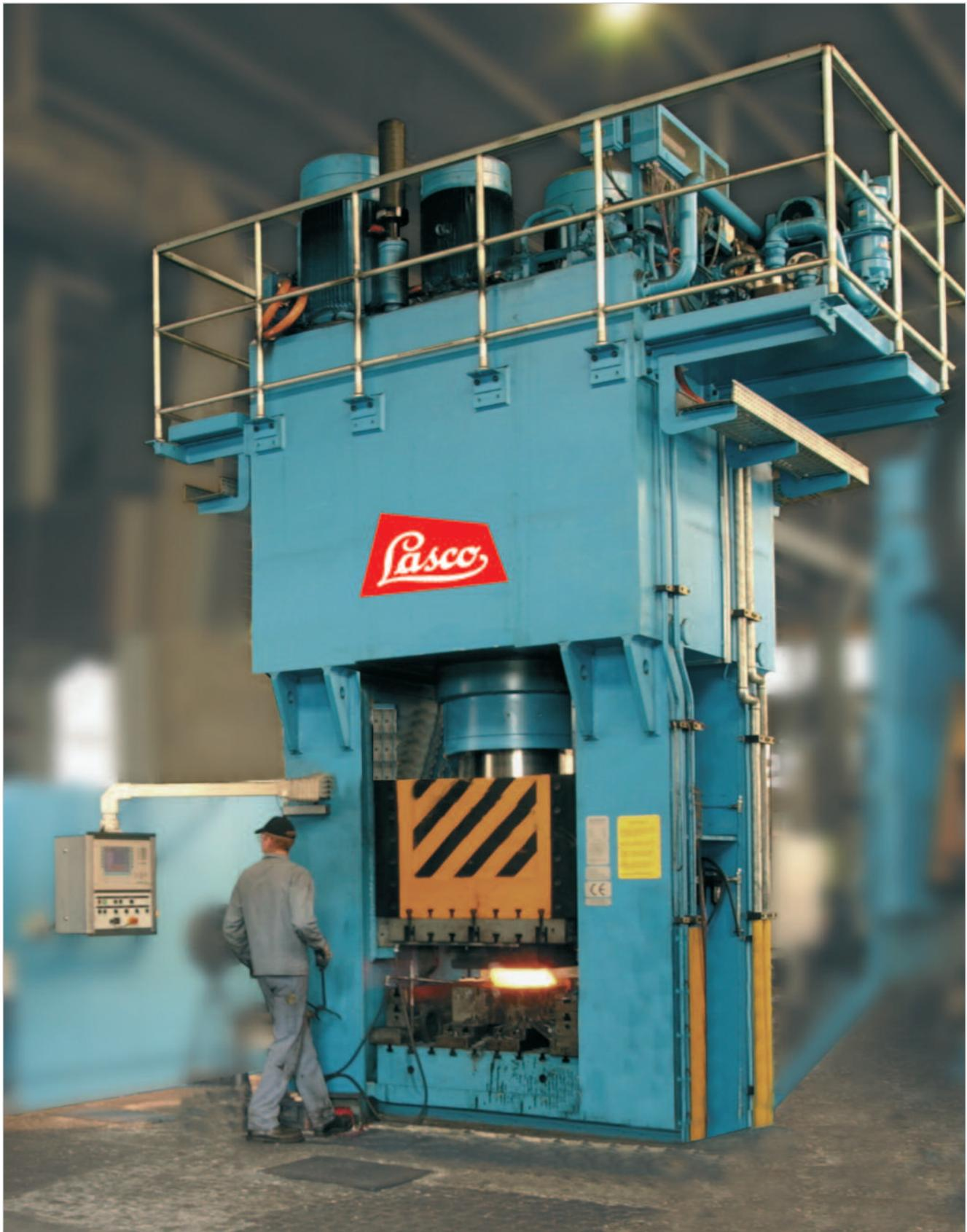
Штамповка кольцевых заготовок на прессе LASCO VPE 800.
