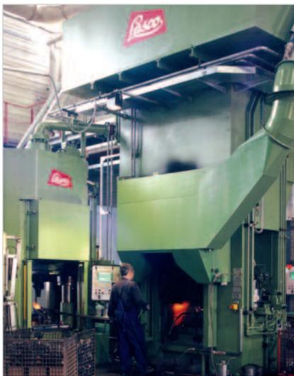
Изготовление поршней на прессах VPE 160 и VPE 500.
