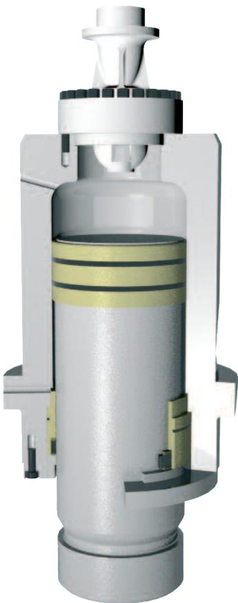
Схематическое изображение цилиндра гидравлического пресса производства LASCO.
