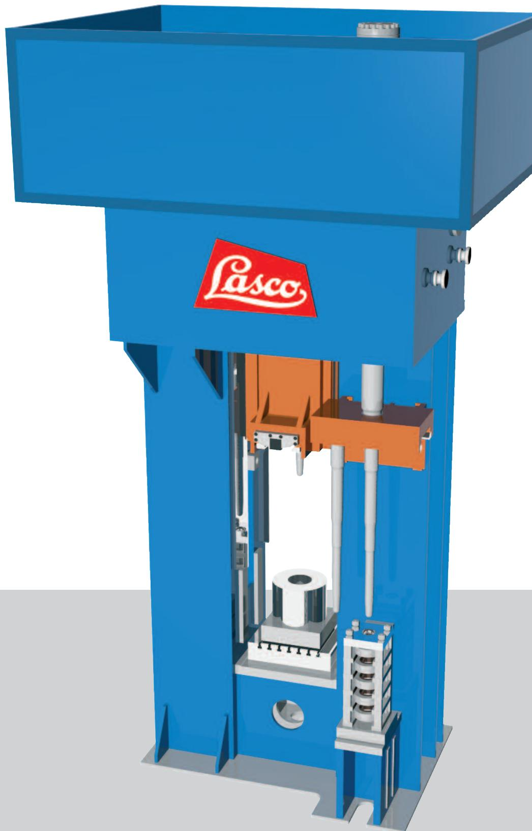
Комбинированный дыропробивной и вытяжной пресс VPZ для производства вращательно-симметричных поковок (схематическое изображение).
