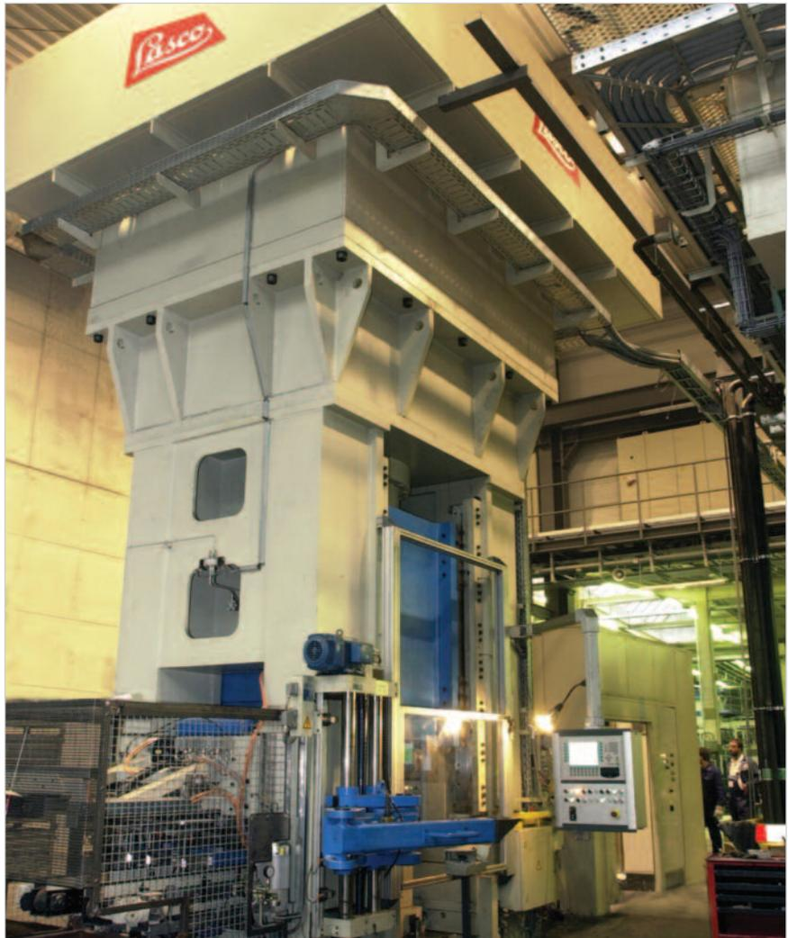
*Пресс для холодной штамповки KFP 1000 производства LASCО на участке изготовления автомобильных деталей. Один из более тысячи гидравлических прессов компании LASCО, работающих на промышленных предприятиях во всем мире.*
