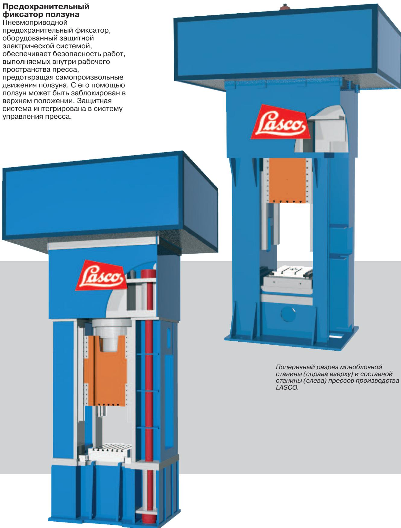
Поперечный разрез моноблочной станины (справа вверху) и составной станины (слева) прессы производства LASCO.
