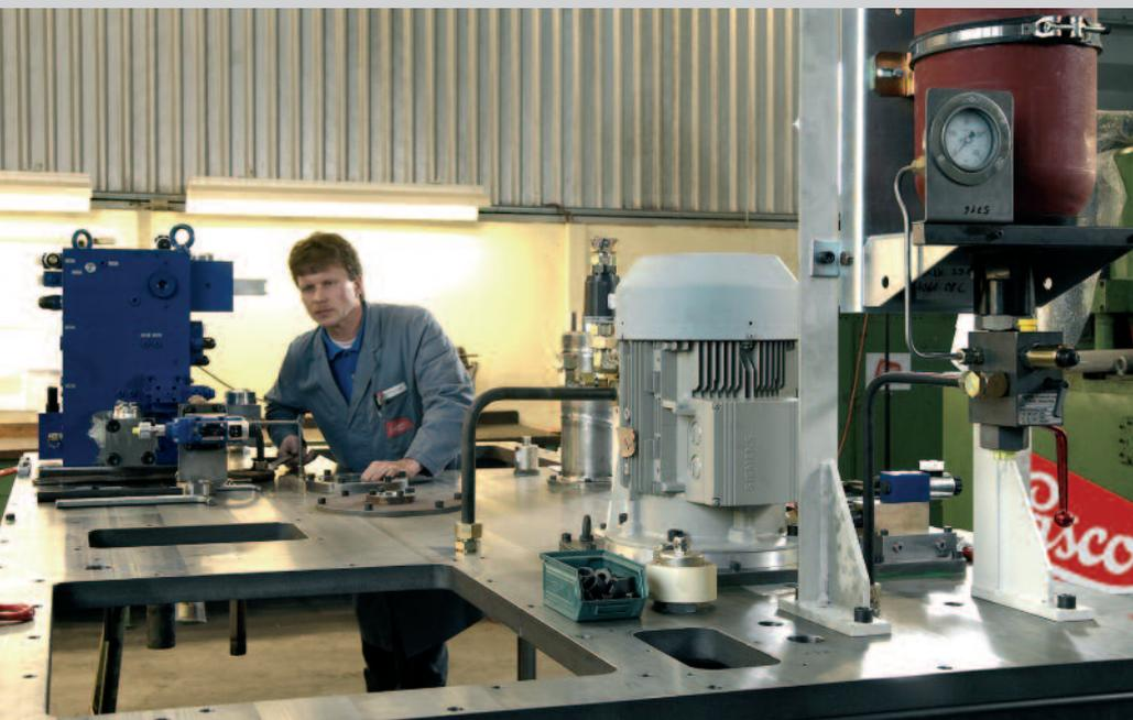
Специалист компании LASCO за монтажом гидравлического привода пресса VPE.
