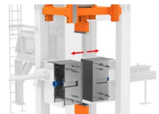
Verstellen der Seitenplatten
