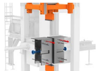
Entriegeln des Werkzeugs
