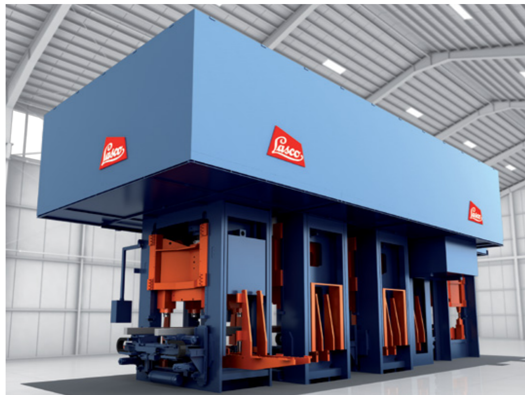
Ligne de presses composée de cinq presses d'emboutissage
