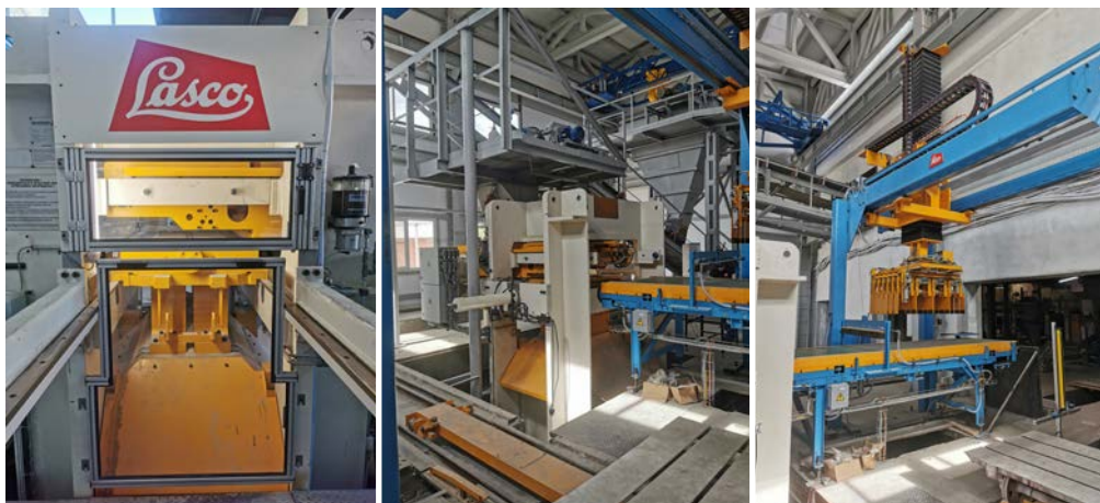
Фотографии из цеха ТОО «Силикат» Семей, сделанные во время проведения монтажа новой прессовой установки KSE 401 В LASCO для производства силикатного кирпича.
