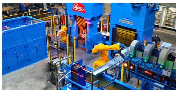
Ligne de forgeage semi-automatique avec marteau LASCO HO-U 500, convoyeur à escalier, chauffeuse et robots.
